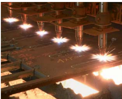
172_ Grobbearbeitung: Brennschneiden kann die Folgeprozesse entscheidend beeinflussen.
