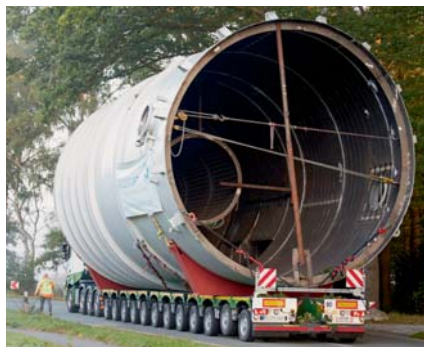
96_ Schwertransport: Der 105-Tonnen-Wirbler wird auf einem Combimax befördert.
