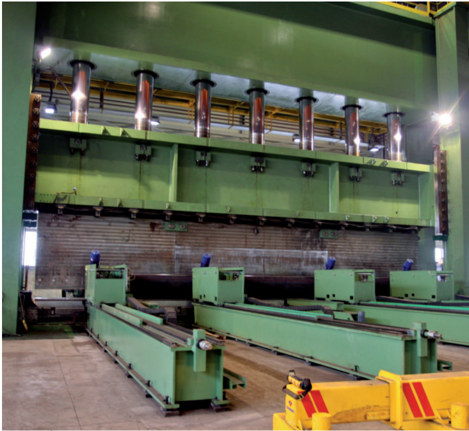
Ausgerüstet mit einer neuen Gräbener-Hydrauliksteuerung sowie einem neuen Rohr- und Blechhandlingsystem erstrahlt die Biegepresse bei Cimolai S.p.A. in neuem Glanz
