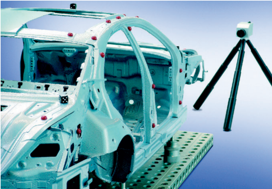
Fixinspect-Adapter zur Beschleunigung von Messvorgängen: Die roten Halbkugeln sind für taktile Messungen, die mit codierter Punktmatrix versehenen Würfel-Adapter für Photogrammetriesysteme bestimmt
